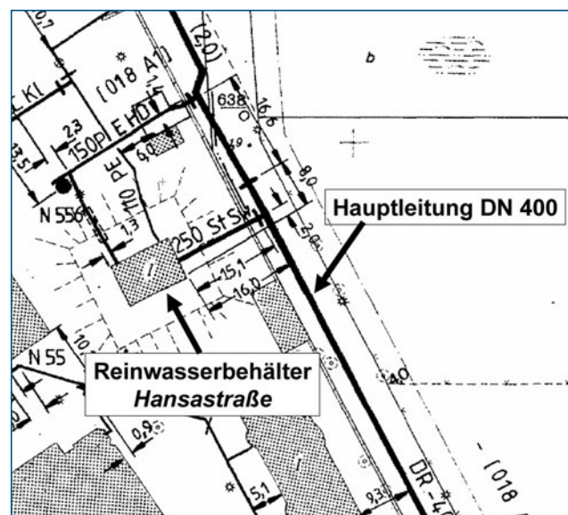
Abb. 1 Außenansicht (links) und Netzeinbindung (rechts) des Reinwasserbehälters „Hansastraße“
